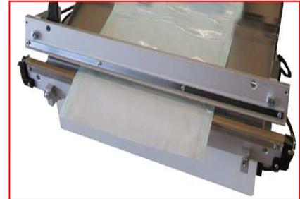
Le saldatrici a pinza consentono la giunzione del bordo di due film sovrapposti
