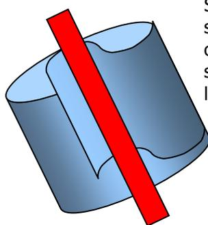
Su alcuni materiali le barre saldanti tipo "soft bar" opportunamente posizionate e supportate possono saldare un lembo alla bobina
